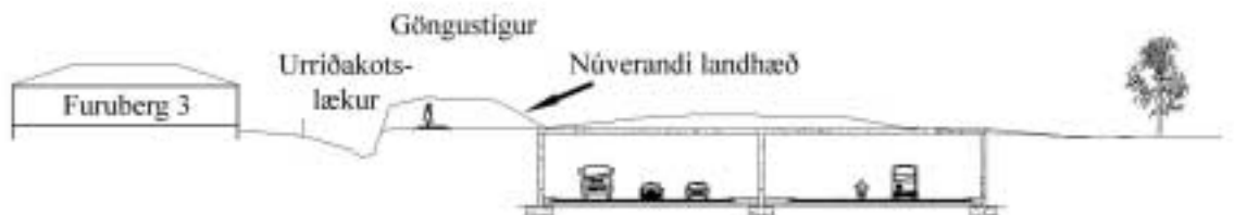
Mynd 3.8. Þversnið mögulegs vegstokks á mótis við Sólvang. Á sniðinu sjást tvær akreinar í hvora átt og að- og fráreinar mismislegra gatnamóta við Lækjargötu.
