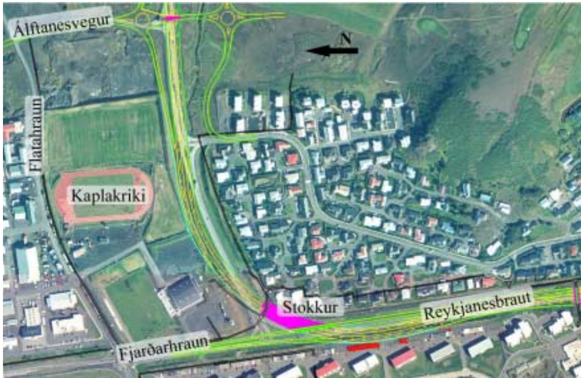
Mynd 3.3. Vegstokkur við Kaplakrika og mislæg gatnamót við Fjarðarhraun. Svartar línur tákna göngu- og hjólaleiðir.
